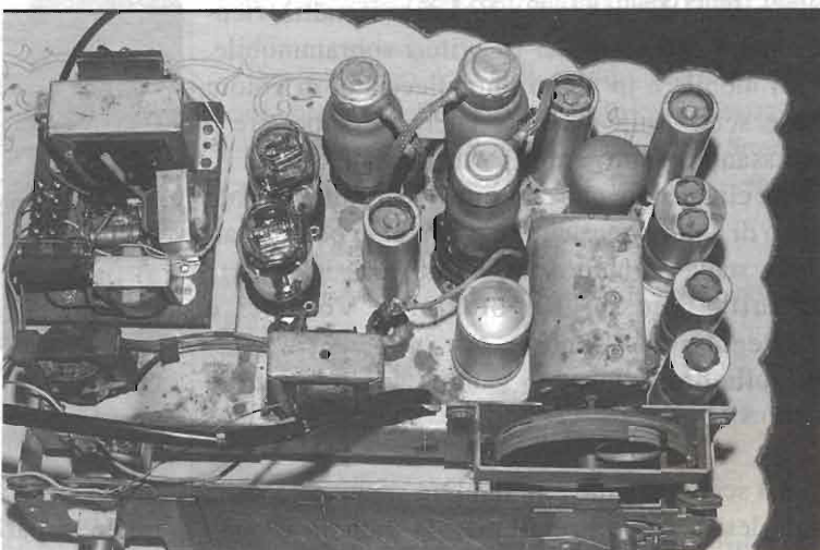
Foto 4 - Telaio visto dall'alto. Sulla sinistra in alto l'alimentatore da C. alternativa.
